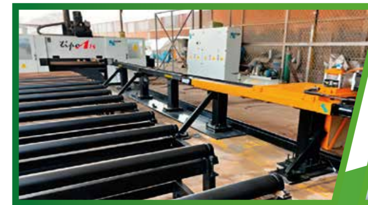
CNC DE CORTE PERFORADO EN VIGAS
